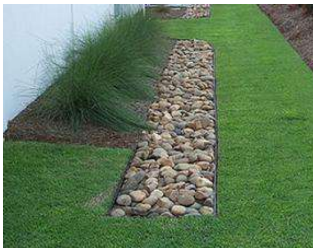
Figura 55: Modelo de trincheira de infiltração
