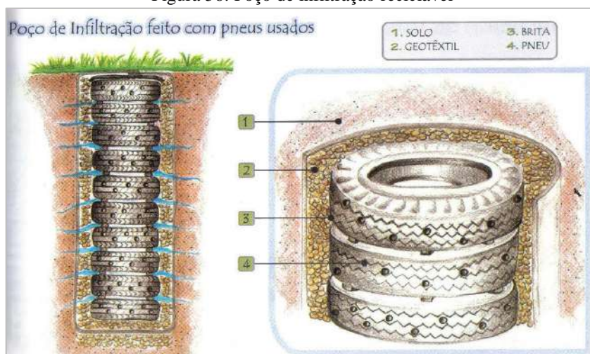
Figura 56: Poço de infiltração reciclável
